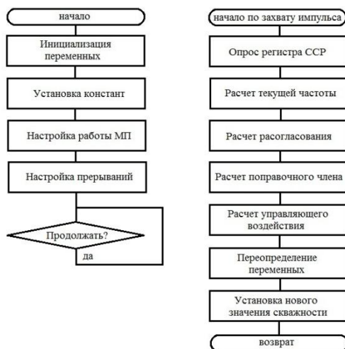
Рис. 2 – Алгоритм работы основной (слева) и фоновой (справа) программ.
