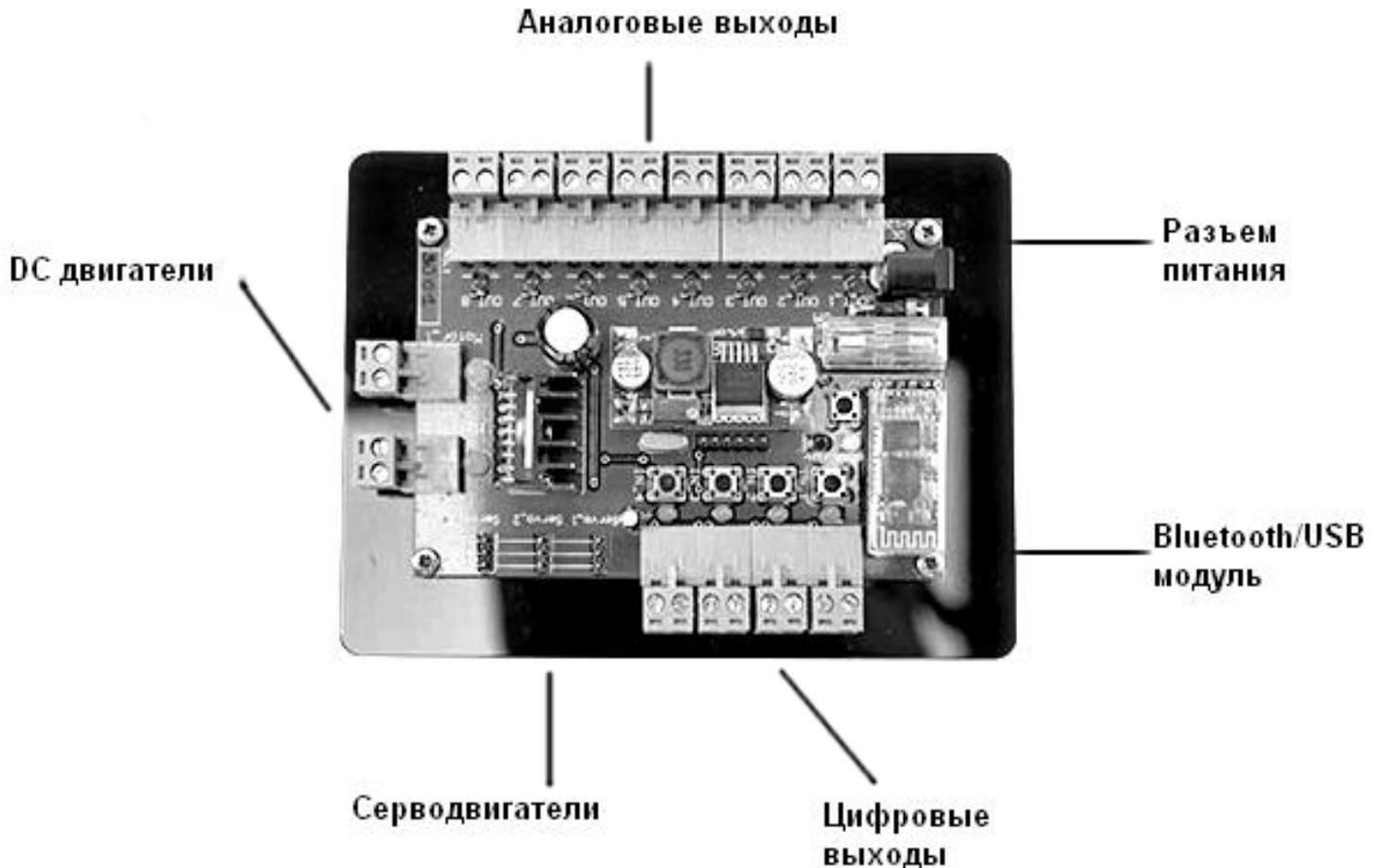
Рис.11 – Структурно-функциональная схема Oktopod\_Board
