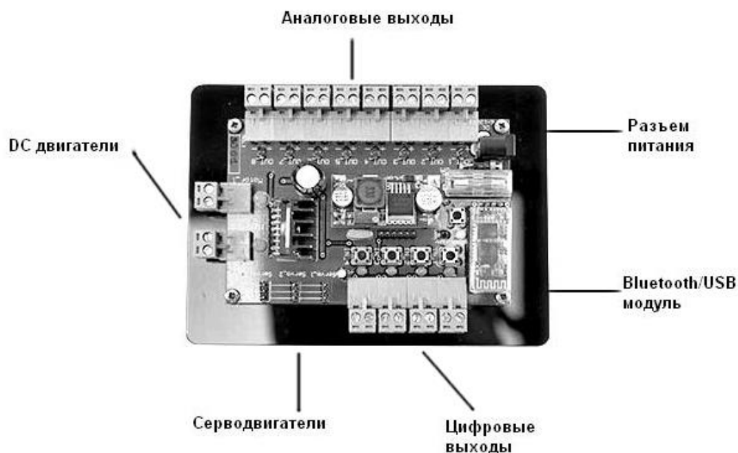
Рисунок 11 – функциональная схема Oktopod_Board
