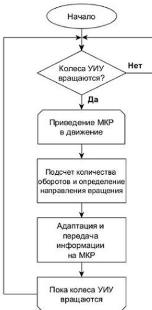
Рисунок 3 – Алгоритм работы системы управления шасси
