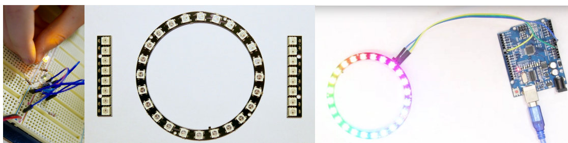
Рисунок 2 – светодиодный индикатор с программной регулировкой цвета
