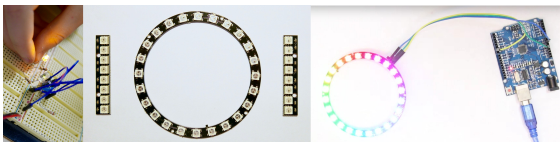
Рисунок 2 – светодиодный индикатор с программной регулировкой цвета
