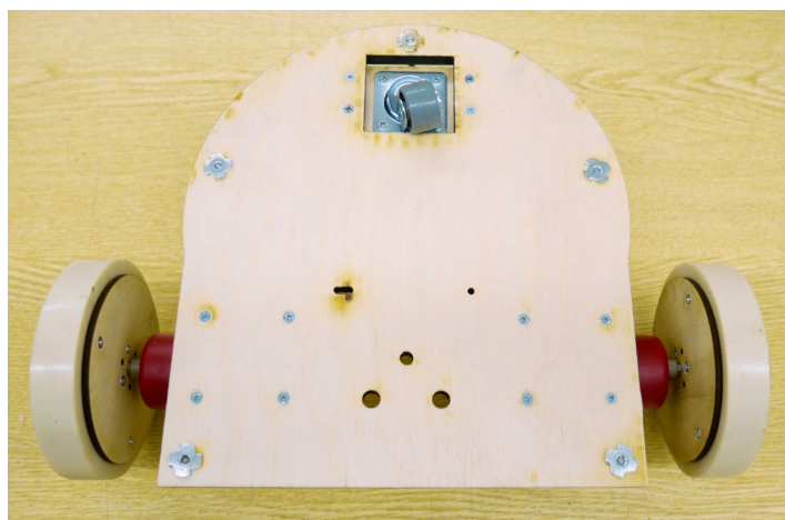
Рис.1 – популярная схема расположения колес и внешнего вида шасси мобильного робота
