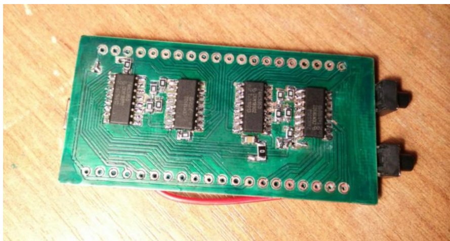
Рис.6 – Нижний слой с нанесённой маской и компонентами
