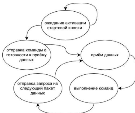
Рис. 1 – машина состояний MR.
